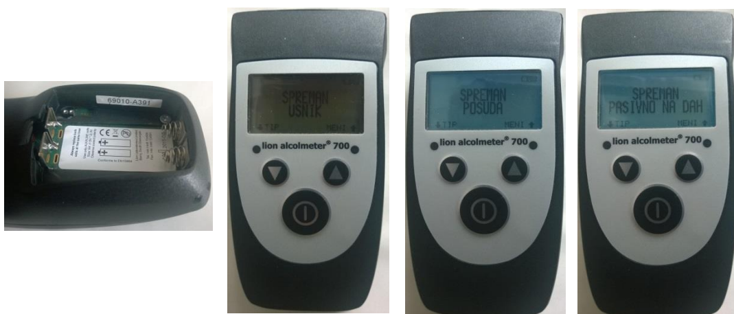
Slika 2. Prikaz mjesta gdje je zalijepljena traka s upisanim serijskim brojem uređaja i prikaz LCD zaslona za tri vrste ispitivanja
